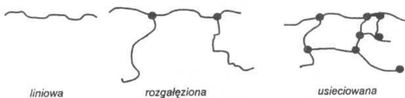
Rys. 2.1. Konfiguracja makrocząsteczek większości popularnych polimerów
